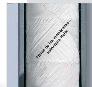
La estructura de arrollado "Helix" de las fibras de las membranas permite crear una mayor superficie de separación de las fibras exteriores, con lo cual se consigue un reparto más homogéneo del aire y, con él, un mayor rendimiento en menos espacio.
